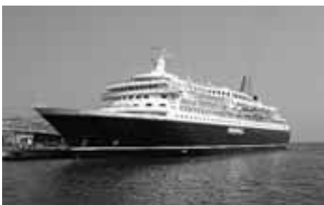
七尾港からクルーズする大型客船「につぼん丸」 総トン数：21,903トン 航海速度：18ノット 全長：166.4m 全幅：24.0m 吃水：6.5m 定員：600名
