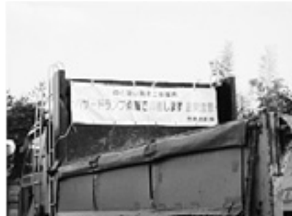
工事車両に取付けた後方注意幕
